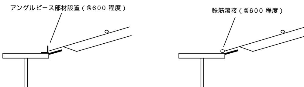
また敷き込み方向が勾配となる場合は、安全上、下側から上側へ向かって敷き込む施工（割付）とする。
