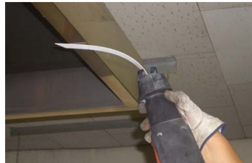
切断刃を90° 近くまで屈曲させて切断可能
