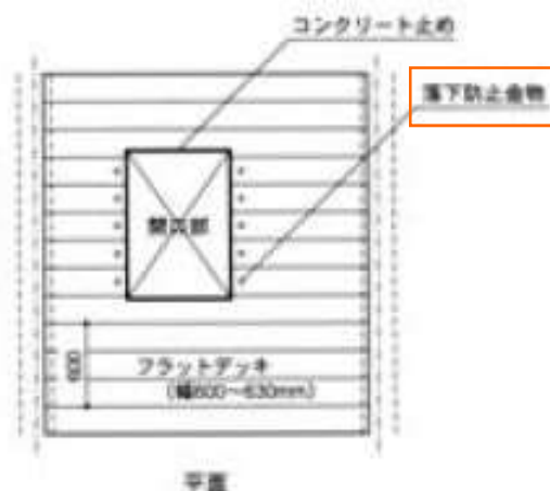
図ー1 コンクリート硬化後にフラットデッキを切断する場合
